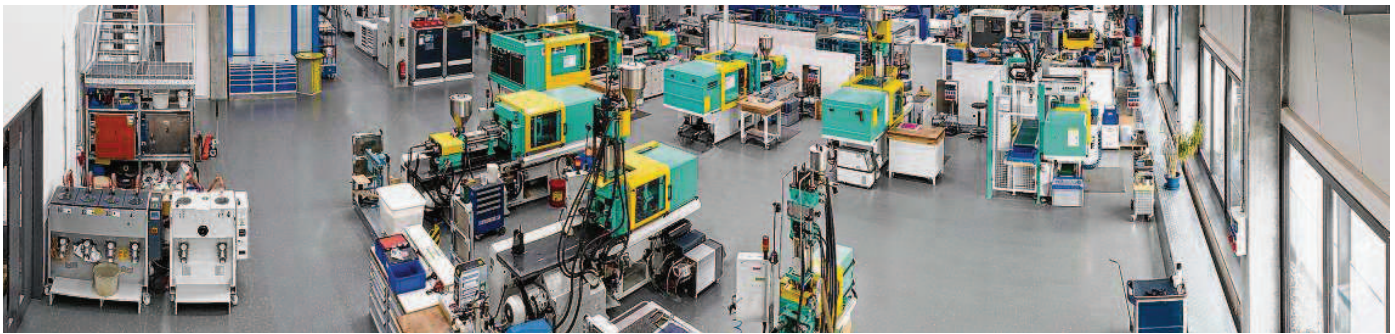
Ein Blick in die Produktion der Firma VMR zeigt im Vordergrund die Spritzgussabteilung, hinten links die CNC Zerspanung und hinten rechts den Formenbau. BILD: VMR
